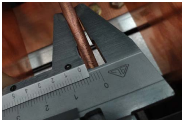
配电母线厚度照片
