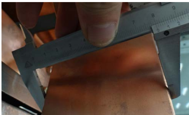
配电母线宽度照片
